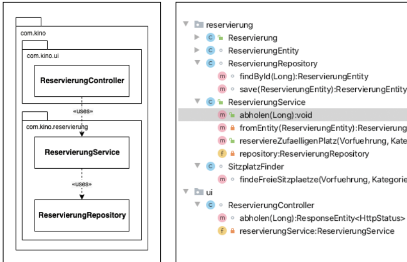
Abb. 8: Die UI-Komponente kann die gleichen Schnittstellen des Moduls benutzen wie andere Module
